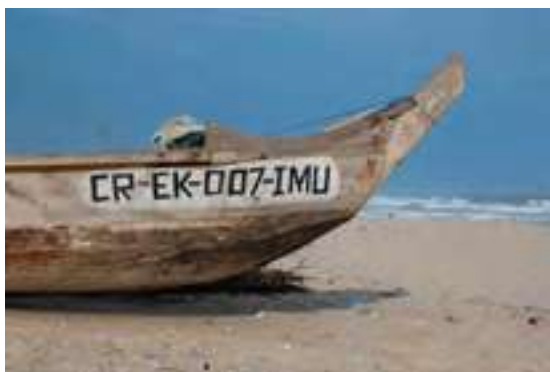
Canoa hecha de una sola pieza tallada del Wawa, un enorme árbol originario de África.
